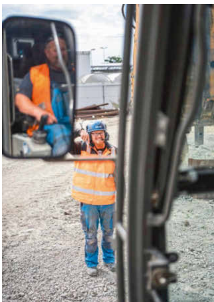
Auf der Baustelle am Flughafen in Bremen kommuniziert der Maschinenführer mit dem Kollegen über das Ancor Headrest System.
